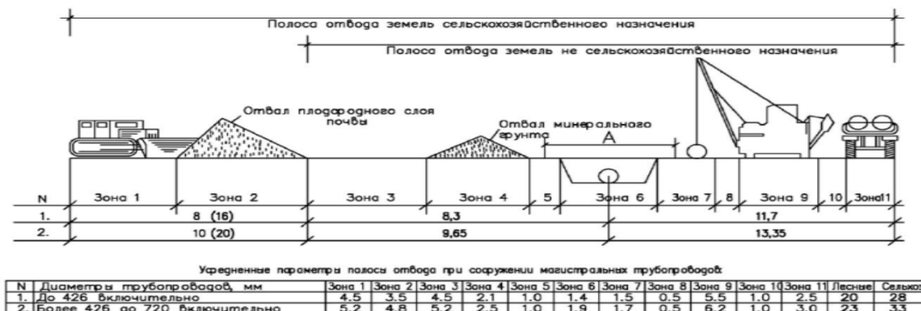
Рисунок 8.1 – Схема полосы отвода при строительстве магистральных трубопроводов
